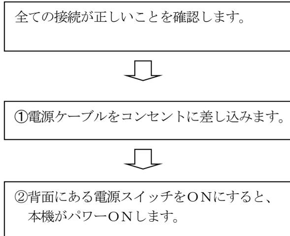
⑨ 電源ケーブル 3極グランド付 AC100Vの電源コンセントに差し込みます。
