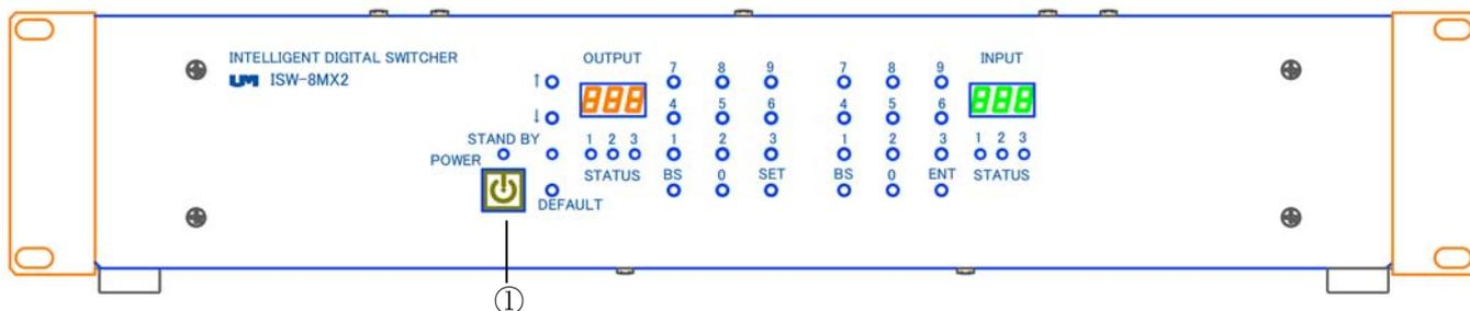
①のスイッチを長押しすることで電源ON（緑色点灯）スタンバイLED消灯
